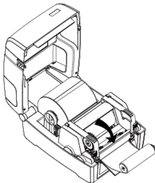
Рисунок 13. Схема загрузки красящей ленты
