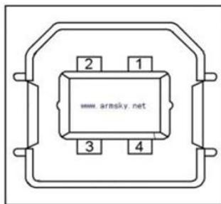
Рисунок 26. Разъем интерфейса USB
