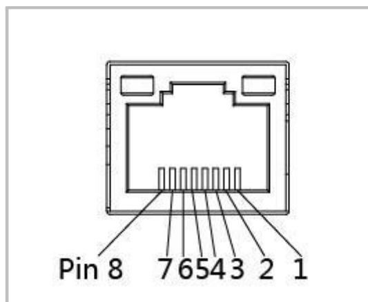
Рисунок 28. Разъем интерфейса Ethernet
