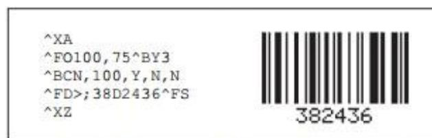
Рисунок 5. Блок С с игнорируемым буквенным символом
